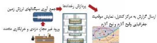
سیستم آلام ورود غیر مجاز به حریم خطوط لوله
