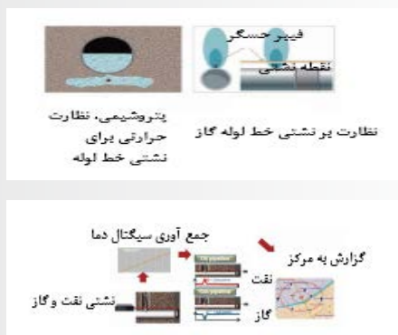
سیستم آلام نشتی از خطوط لوله
